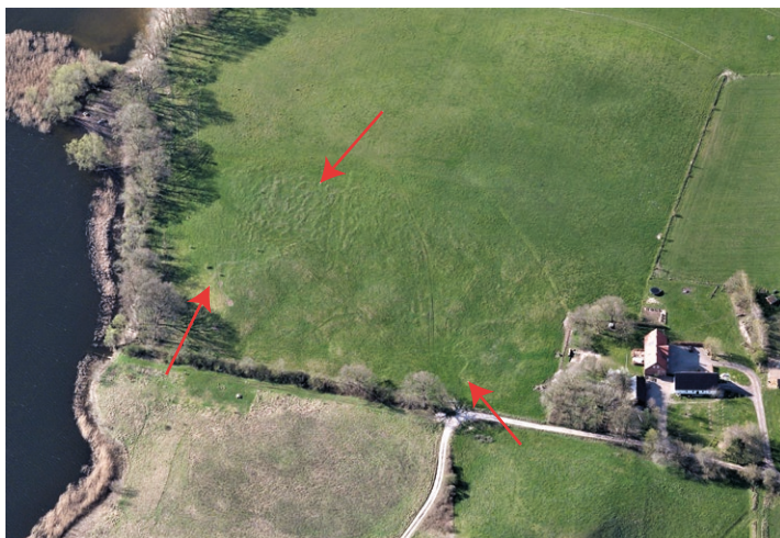
Fig. 5. Skråningsdeformation sker når de øverste lag i en hel skråning eller fjeldside er i bevægelse. Foto af jordkryb (markeret med pile) på en bakke ned mod Tystrup Sø, Midtjylland, samt skematisk fremstilling vist med hældende træer. Skråfoto fra Styrelsen for Dataforsyning og Effektivisering.
