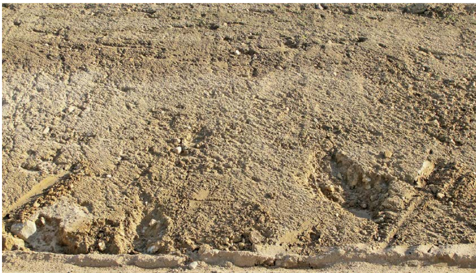
Fig. 14. Smeltevandssedimenter forekommer i alle dele af vejtracéet. I dette profil kan man over en strækning på 200 meter følge en meget ensartet og 10 meter høj skrånelse. Øverst i profilet ligger horisontalt lejrede topset lag. Derunder fortsætter lagene i de høje forset lag. Sedimentet er sand med små forekomster af grus og spredte sten. Smeltevandfloden, der aflejrede dette delta kom fra en nordlig retning. Profilet er 10 meter højt og er beliggende i område 5. Syd er til højre i fotoet.
