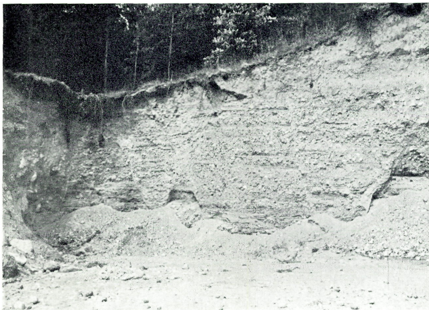
Fig. 5. Grænsen mellem morænegruset og smeltevandsgruset sydligst i nordvestvæggen i Keldbjærg. Morænegruset ses tilvenstre i hele væggen med en uregelmæssig, lodret grænse mod de vandrette lag af smeltevandsgrus. Disse er gennemsat af skrå forkastninger, der især giver sig til kende ved de to A-formige figurer over skredkeglerne i billedets højre rand og tilvenstre for midten. Disse skrå forkastninger er øjensynligt opstået ved en sætning i lagene, da isen, der efterlod morænegruset smeltede bort. Væggens overkant udgøres af bunden af en ældre grusgrav.
