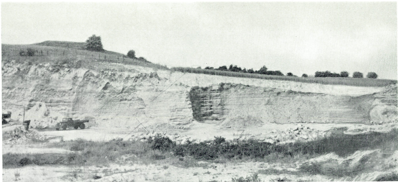
Fig. 1. Nordvestvæggen i grusgraven i Keldbjerg med udskyllet morænegrus over vandrette lag af smeltevandsgrus, aflejret af vand, der er strømmet nordøstpå (tilhøjre) med stenstørrelsen aftagende i denne retning. Lagene ligger her ganske uforstyrret.
