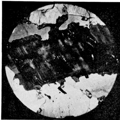
Fig. 11. Antiperthit bestående af plagioklas (tvillingstriber) med uregelmæssige, mørke pletter af orthoklas. Feldspaten er korroderet af kvartskorn. 2 + nic., 28 ×. Ronne-granodiorit. Lok.: Klippeløkken stenbrud.
