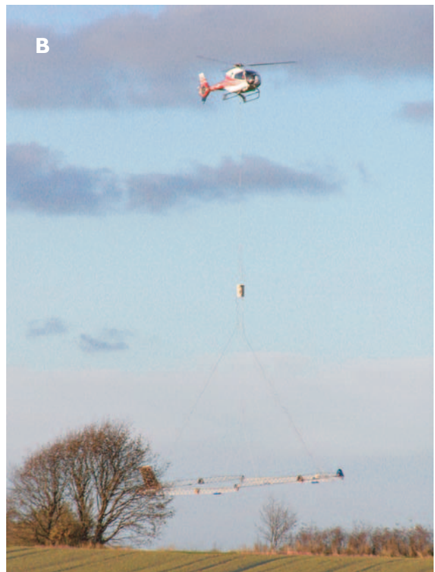
Figur 1. Eksempler på kontinuerte målesystemer. A: det elektriske PACES system, B: det luftbårne transient elektromagnetiske SkyTEM-system.
