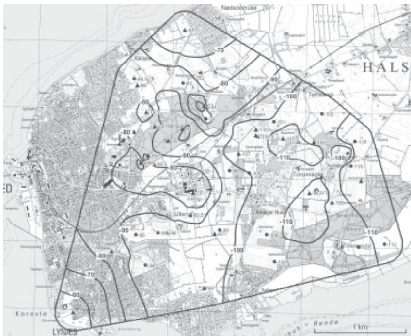
Figur 1. Konturkort over saltvandsgrænsens beliggenhed med angivelse af datapunkter og punktværdier. Trekanter angiver geoelektriske sonderinger og cirkler transient elektromagnetiske (TEM) sonderinger.
