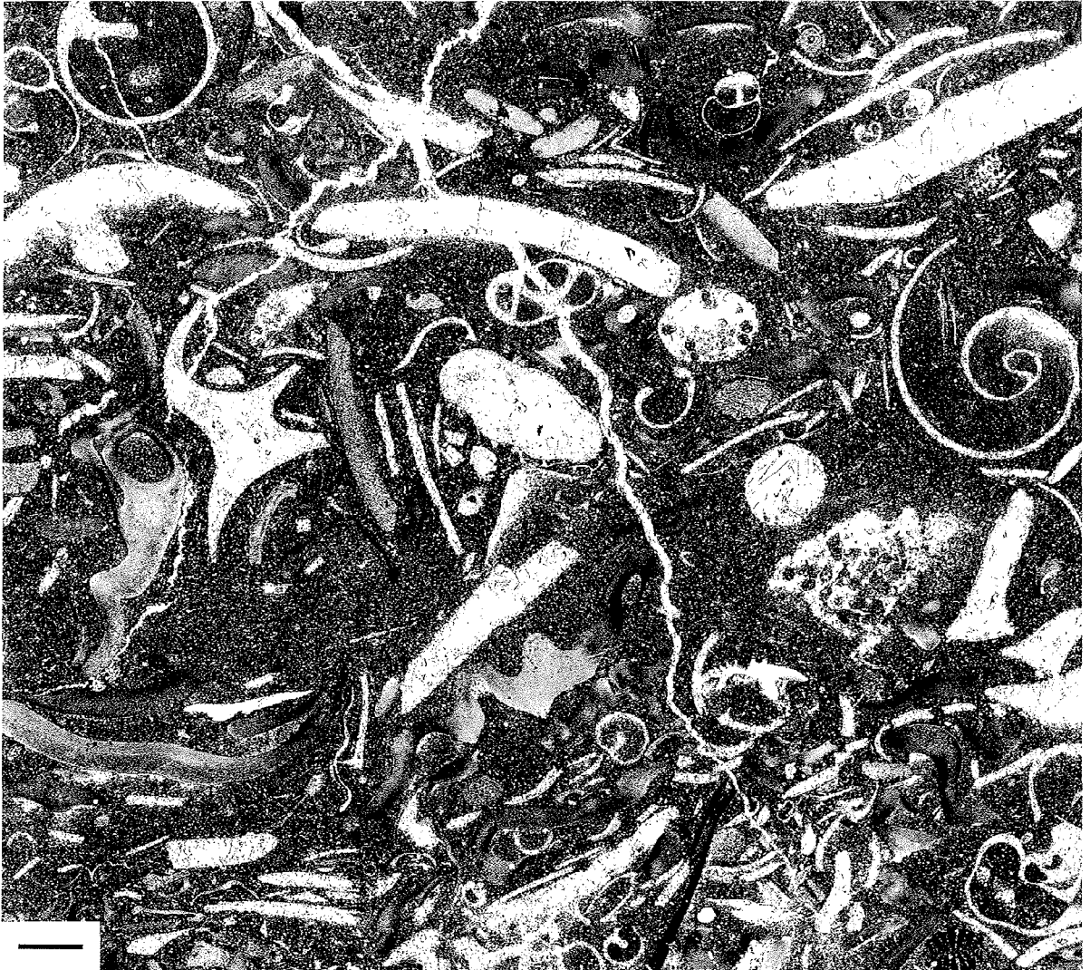
Fig 9. Peel af kalksten fra Silur, Gotland, Sverige. Biomikrit, der viser kornunderstøttet tekstur. Hvid kalcit-udfyldninger efter opløste (aragonitskallede) mollusker i kontrast til grå korn af kalcitiske skaller (mest brachiopoder). Målestokken er 1 mm.
