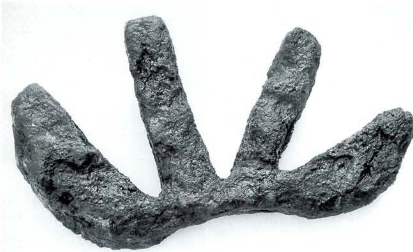
Fig. 5. Klode, dvs. firdelt halvfabrikat af slaggeholdigt jern. Vægt 8,2 kg. Fundet i Karup Å og formentlig fra omkring 1400–1500. Bredde 40 cm. Fra Buchwald 1991.
