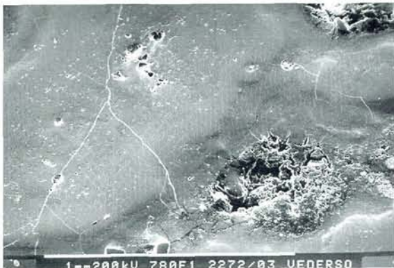
Fig. 20. Polerprøve af fast dansk myremalm fra Vedersø, Hing herred. Krakeleret limonit af ujævn hårdhed og med porøse områder til højre. Målestok 1 mm. Philips SEM foto.
