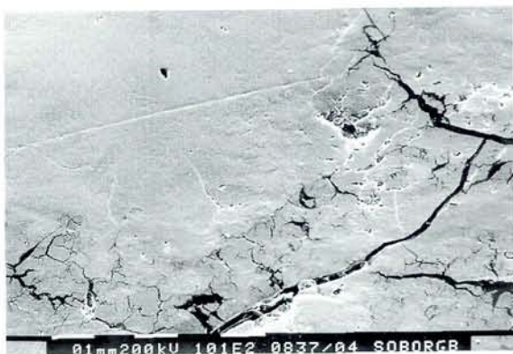
Fig. 24. Polerprøve af fast dansk myremalm fra Søborg, Nordsjælland. Tætte partier til venstre veksler med mere åbne, krakelerede partier. Målestok 0,1 mm.
