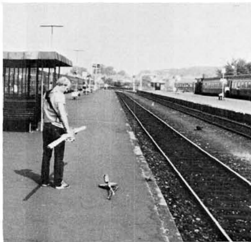
Fig. 5. Måling med Stangslingsramme. (Geonics EM 31).
