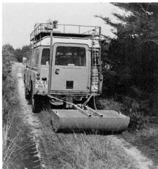
Fig. 2. Måling med georadar. En antenne med en sendefrekvens på 80 MHz trækkes efter en Landrover, hvori det øvrige udstyr er monteret.
