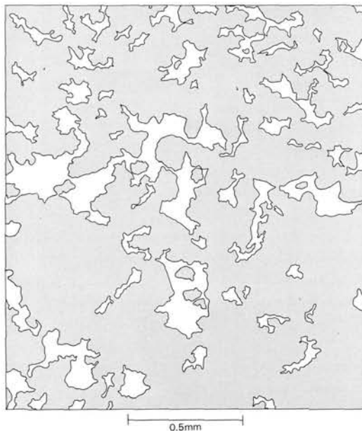
Fig. 4. Slib nr. 3. Skeleton korn i porøse jordaggregater. Tegningen viser uregelmæssigt formede, større porer mellem meget porøse jordaggregater. Planpolariseret lys.
