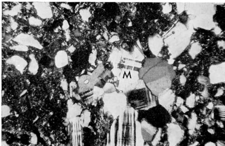
Fig. 4. MM 6295. Ved 'M' sammenhængende mikroklin- og kvartskorn uden mellem-liggende sericit; til venstre matrix med kvartskorn med samme optiske orientering. X 45, 2 nicoller.
