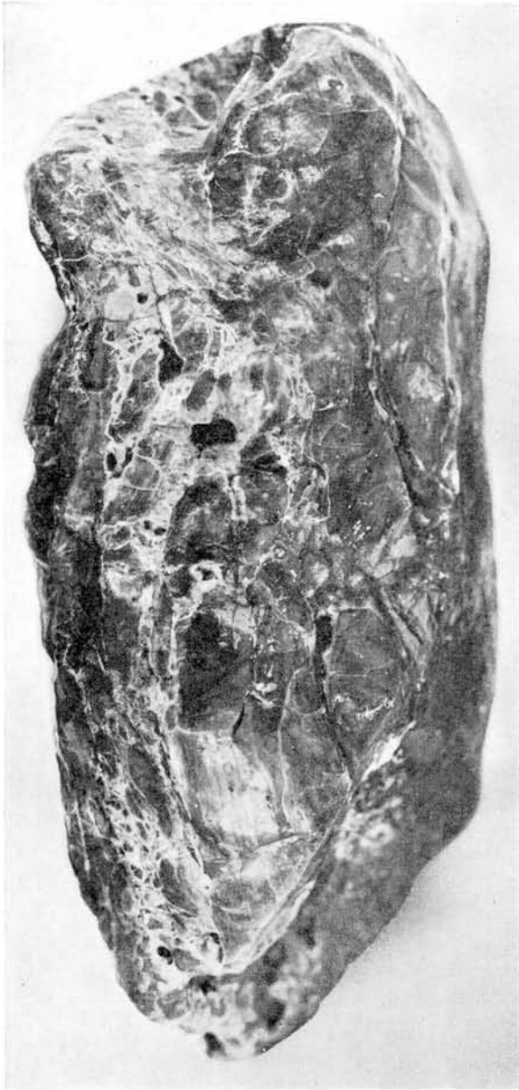
Fig. 12. Ren flintbreccie, sort flint med »båndflint« (forneden). (Sten nr. 231). Nat. st.
